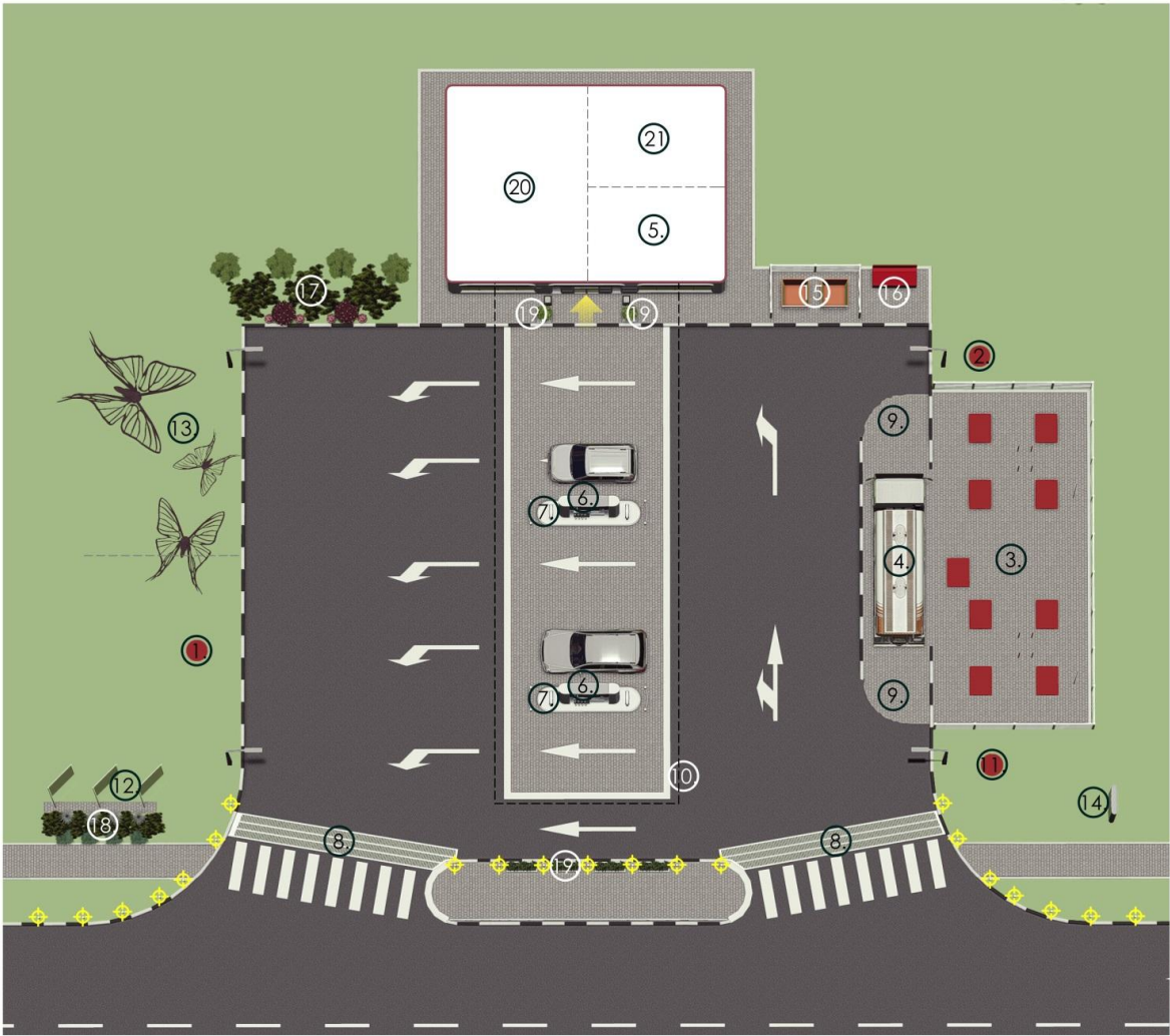
Тип 1.1. Схема планировочной организации городской автомобильно-заправочной станции
