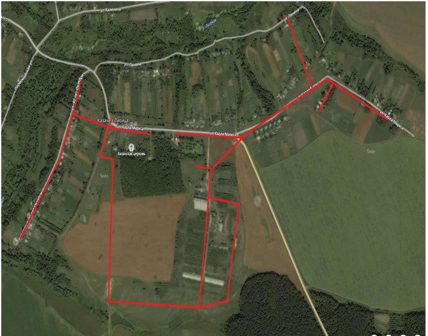
Рисунок 13. Схема водоснабжения с. Казачья Лисица.
