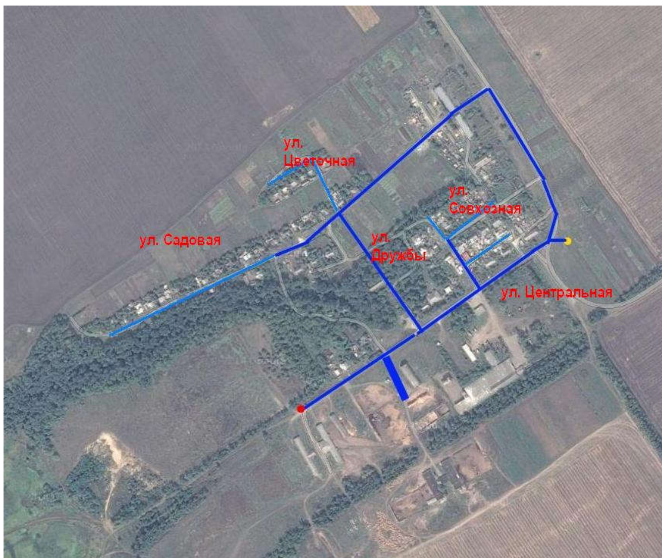
Рисунок 9. Схема водоснабжения п. Чапаевский.
