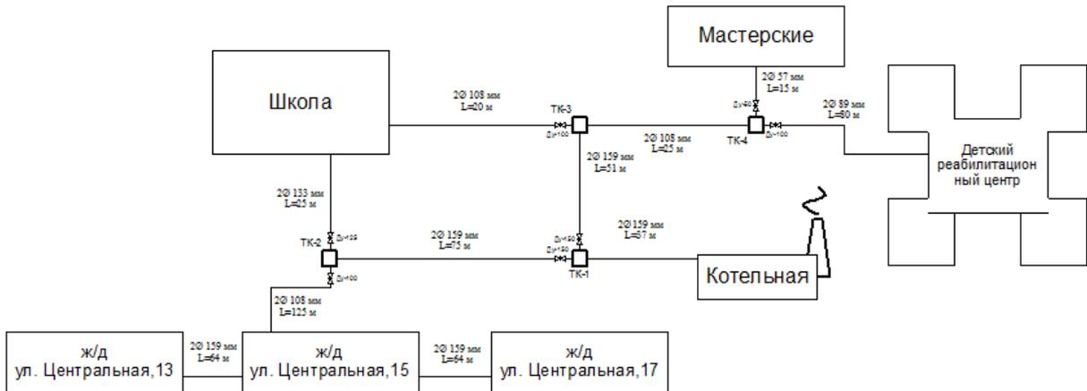
Рисунок 6. Зона действия котельной с. Козинка
