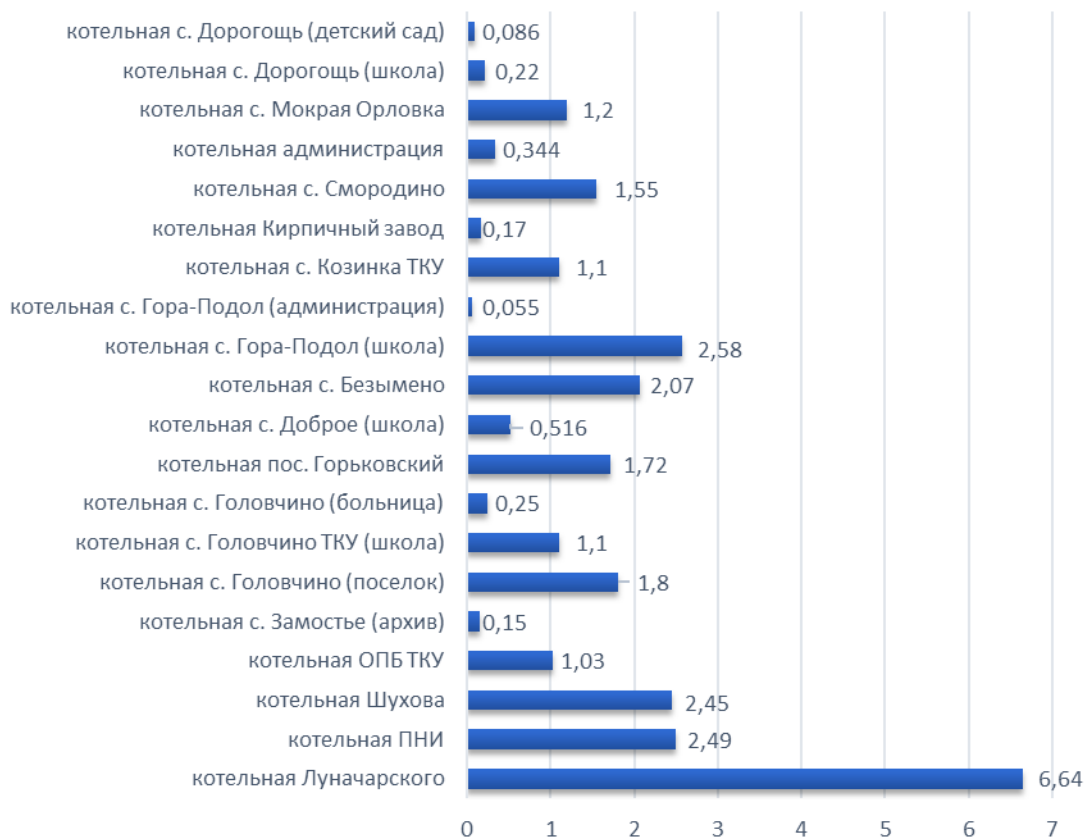
Рисунок 21. Установленная мощность котельных Грайворонского муниципального округа
