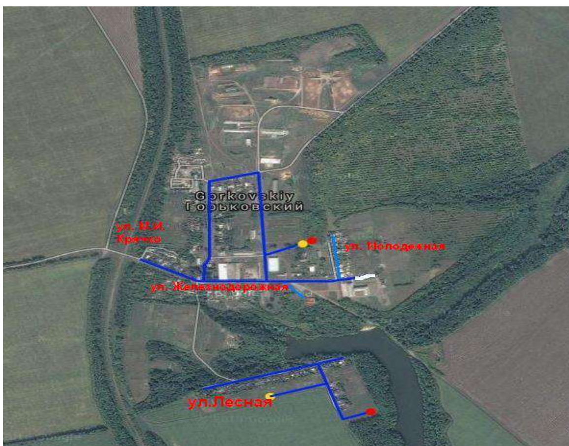
Рисунок 6. Схема водоснабжения п. Горьковский
