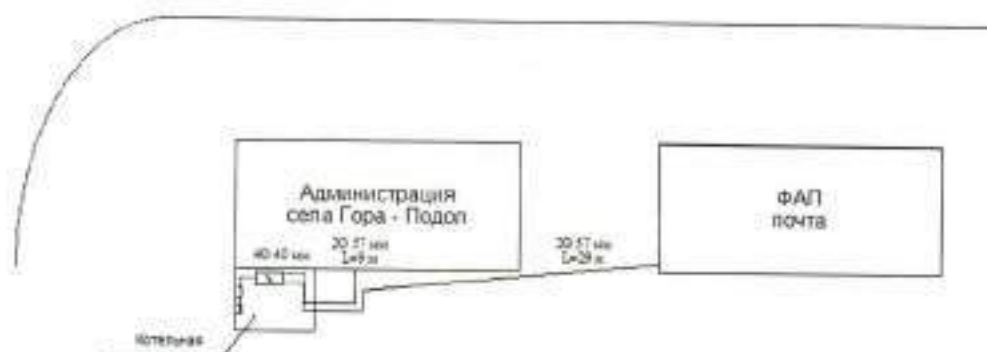
Рисунок 9. Зона действия котельной с. Гора-Подол (администрация)
